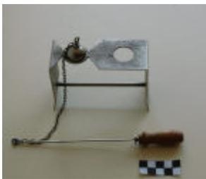
Na maior parte dos casos, o instrumento consiste num eixo metálico vertical, que termina em gancho, onde se suspende uma esfera, também metálica. Abaixo desta esfera, encontra-se o anel metálico com um braço que se fixa ao eixo vertical e que permite elevar ou baixar esse anel. O eixo, por sua vez, está aparafusado a uma base.
